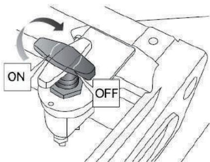
2. Desconecte la batería de bajo voltaje 12V. Asegúrese de haber cumplido con los puntos anteriores. Para realizar este procedimiento, primero retire el borne negativo (-) y luego el borne positivo (+). Espere dos minutos luego de la desconexión.
